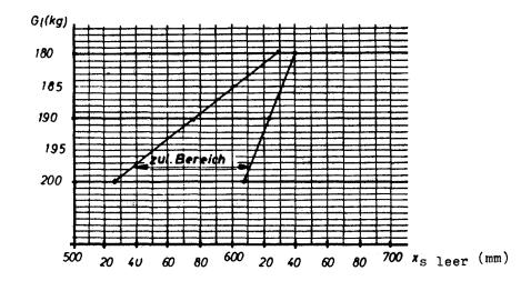
Das Flugzeug ist auf eine Zuladung im Führersitz (Pilot und Fallschirm) zwischen 75 und 110 kg eingerichtet. Bei geringerer Zuladung ist Ausgleich durch Ballast (unverrückbar im Sitz befestigt!) vorzunehmen.
