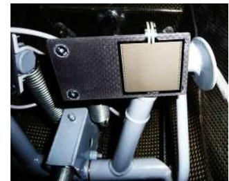
Die Vibrosignale funktionieren mit der neuen Software und können gut über ein Potentiometer justiert werden. Leider stört bei einigen Funkgeräten (z.B. FSG71) ein Rauschsignal, das jedoch laut LXNAV mit einer Softwareänderung demnächst behoben werden soll.
